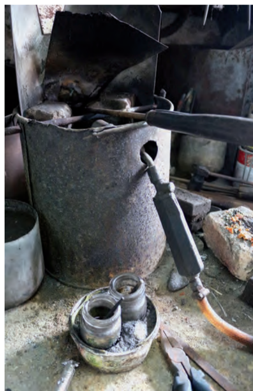
▲店里保留了使用煤气炉来焊铁的旧有方式。
